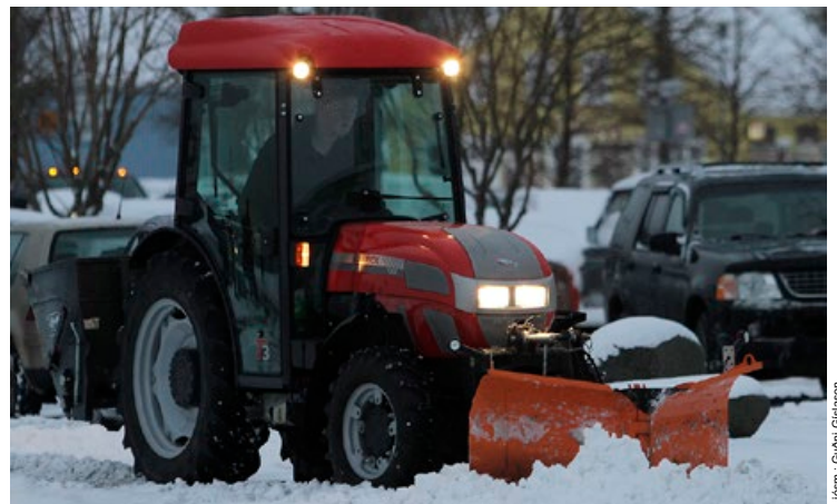
Litill traktor en með sand/salt kassa og fullkominni snjótönn.
